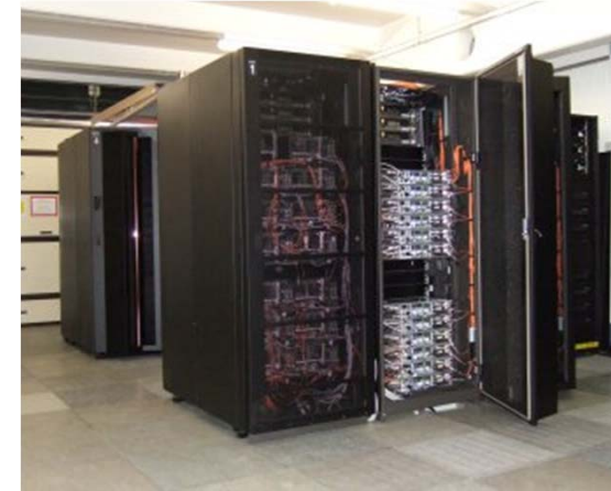
Hessischer Hochleistungsrechner HHLR, Leistung: 500 Giga-Flops bei 96 CPUs, 192 GB Hauptspeicher Quelle: TU-Darmstadt, HRZ
